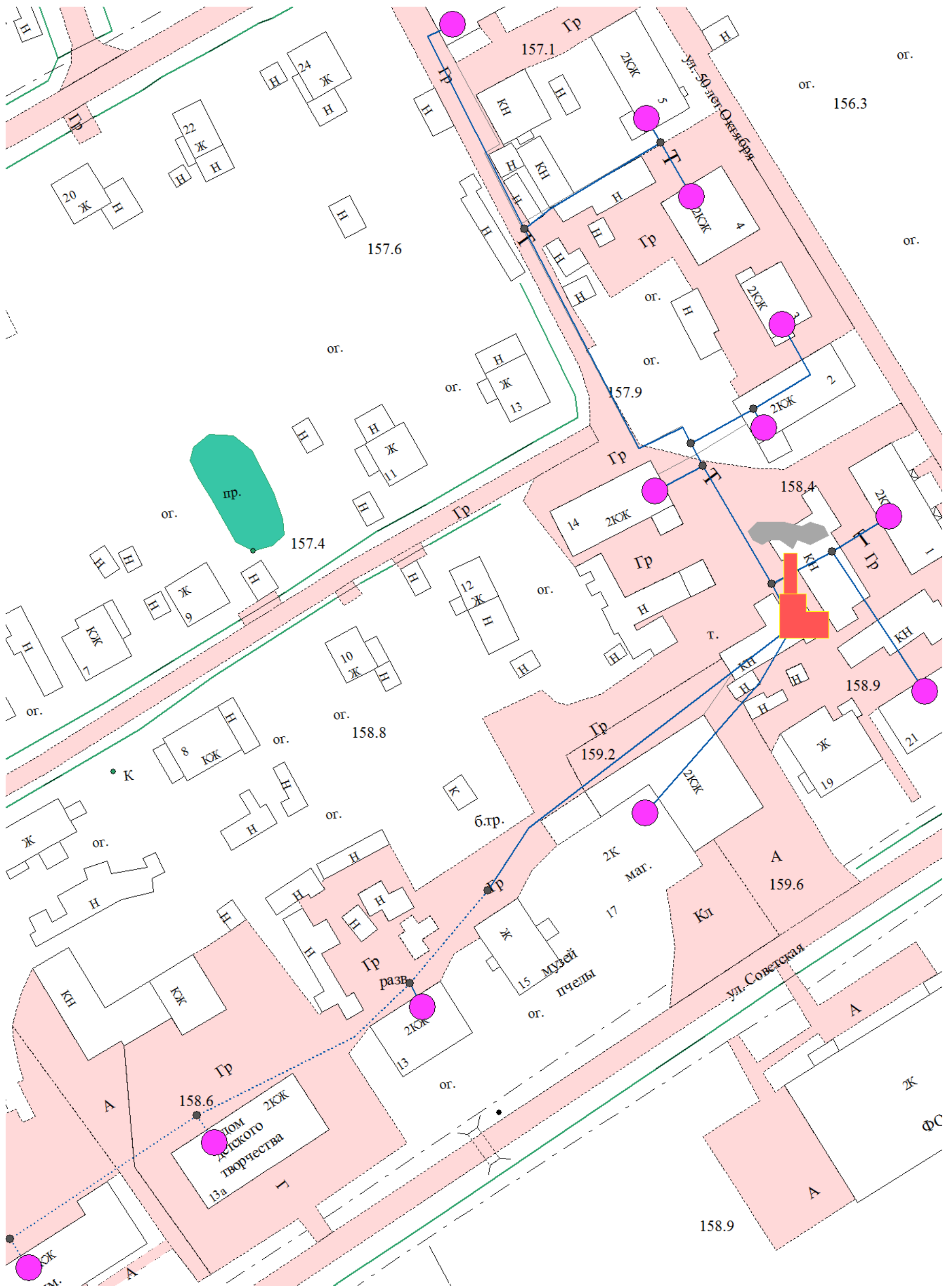
Рис. 1.3.5.1 Существующая схема тепловой сети от котельной №5
